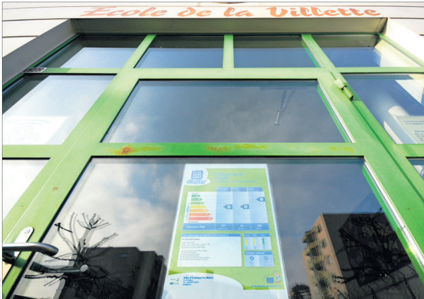
COLLÈGE Trois critères sont reportés sur le document de format A3: consommation d'énergie, consommation d'eau et émissions de CO 2 . Leur valeur est estimée sur une échelle allant de A (économe) à G (peu économe). YVERDON-LES-BAINS, LE 8 FÉVRIER 2010
